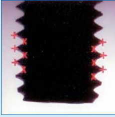
Gewindedurchmesser innen/aussen, Gewindesteigung, Gewindeform Thread I.D./E.D/Pitch Distance/Pitch shape
