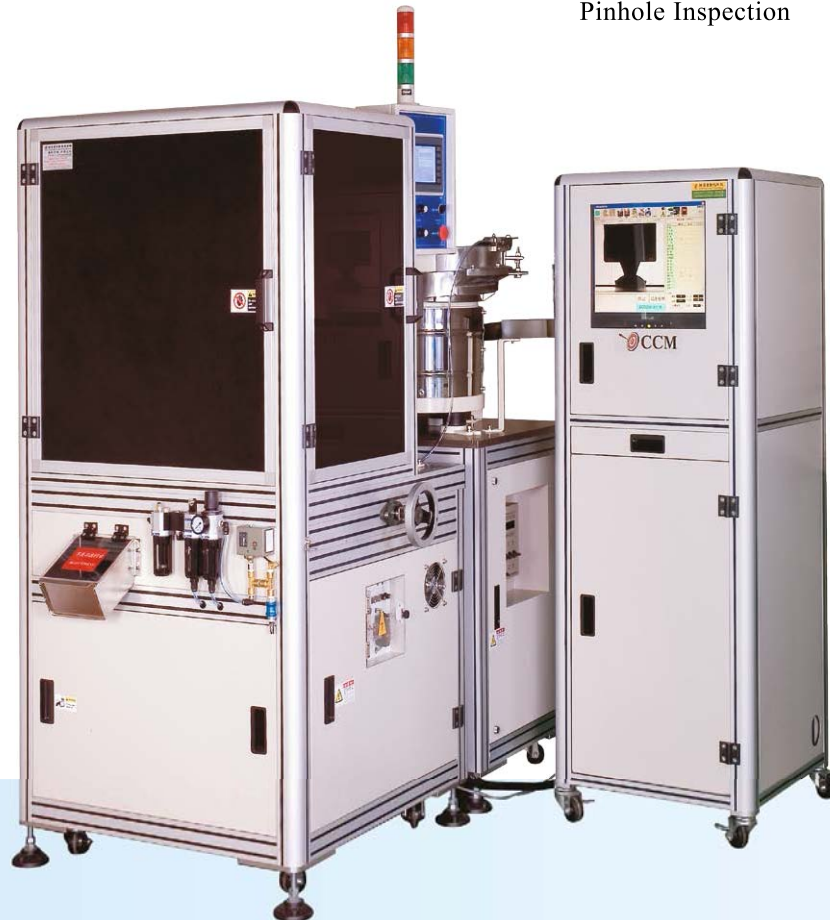
Innenangriffsprüfung Pinhole Inspection
