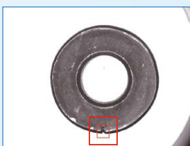
Kopfrisse Head Crack
