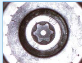
Kopfrisse an der Seite bei verzinkten Schrauben
