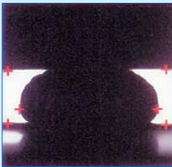
Schraubenkopfhöhe/-durchmesser Screw-head height, width
